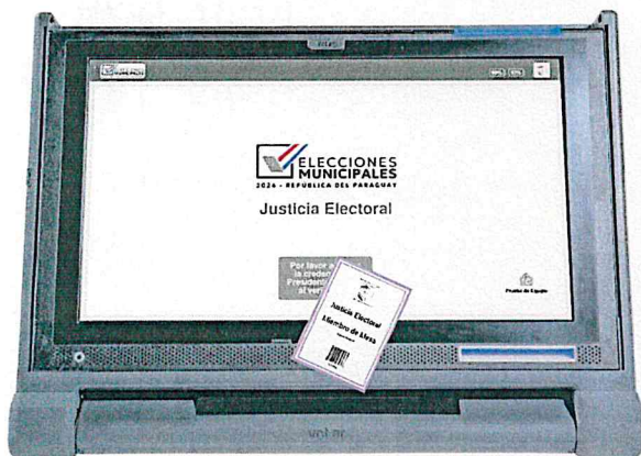
*PANTALLA DE INICIO Y EJEMPLO DE COMO DEBE PASAR LA CREDENCIAL POR EL LECTOR RFID
