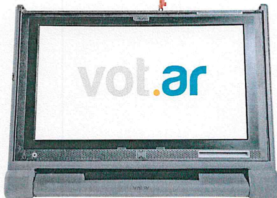
*PANTALLA QUE SE MUESTRA CUANDO EL PENDRIVE FUE LEÍDO CORRECTAMENTE POR LA MV.
