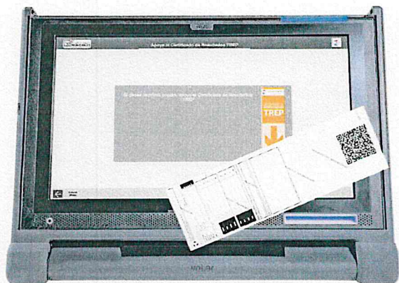
*IMAGEN ILUSTRATIVA QUE MUESTRA COMO DEBE APOYARSE EL CERTIFICADO DE RESULTADOS TREP AL LECTOR RFID
