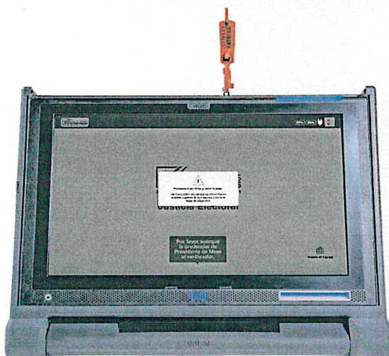
*PANTALLA CON LA ALERTA “SACAR EL PENDRIVE Y CERRAR LA TAPA DE SEGURIDAD”
