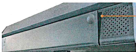
Una vez liberada, girar la tapa hacia arriba para acceder al compartimiento interno.
